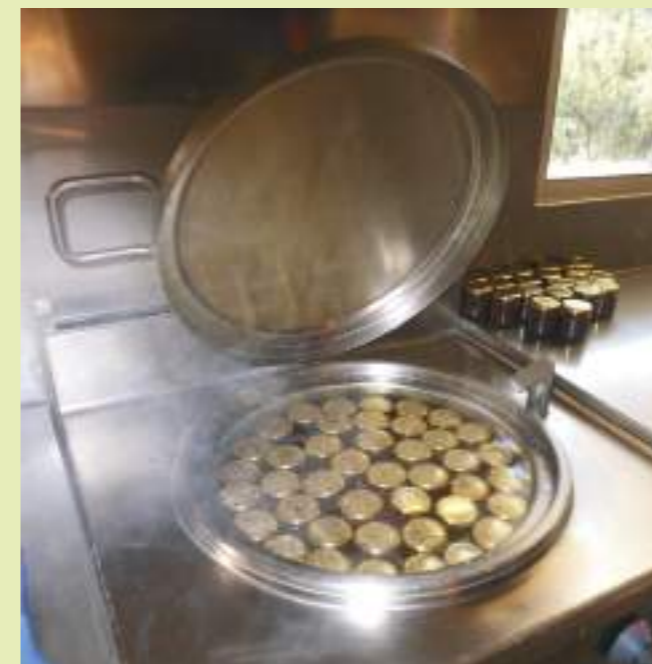
Exemple de pasteurisateur à gaz avec arrivée d'eau en haut (remplissage avec eau chaude solaire permettant de réduire la consommation énergétique)
