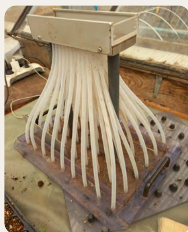
Figure 1 : Système mécanisé, la plaque alvéolée est déposée sur un tapis roulant, est remplie de terreau, les graines y sont déposées (2 à 3 graines), sont recouvertes de vermiculite et arrosées.
